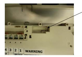
LIFT UP THE CLIP AS SHOWN TO RE-LEASE THE INDUCTION UNIT FROM THE MOUNTING PLATE BY SLIDING FORWARD AWAY FROM THE REMAINING RETAINING CLIPS
