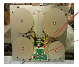
RELEASE 2 XCLIPS FROM PLASTIC MOUNTING BOX
